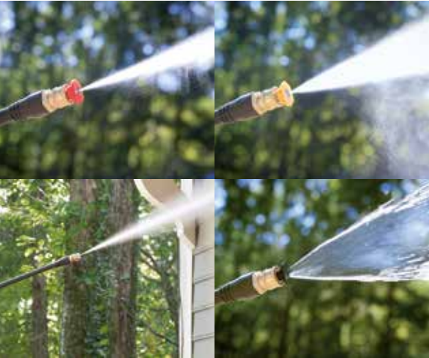
АРТ. 5201407 Набор из 4-х форсунок, 250 бар с различными углами распыления - 0° -для удаления грязи, плесени, краски (использовать с осторожностью!) - 25° –универсальная (заборы, стены); - 40°- для деликатной мойки (автомобили); - форсунка с широким углом распыления для моющего средства
