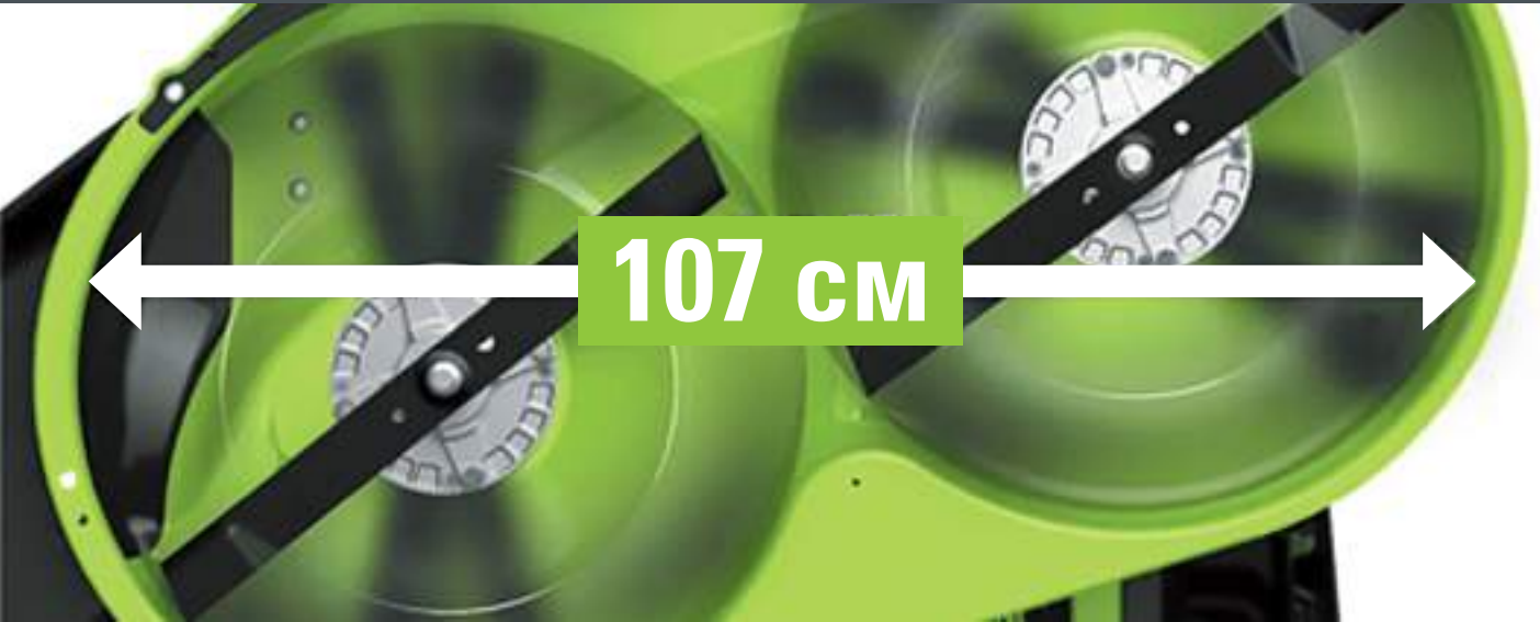
Надёжная стальная дека с шириной скашивания 107 см. Два ножа с прямым приводом от двух двигателей создают восходящий воздушный поток, поднимающий траву. Обороты ножей регулируются: 2 400 / 3 000 / 3 200 об/мин
