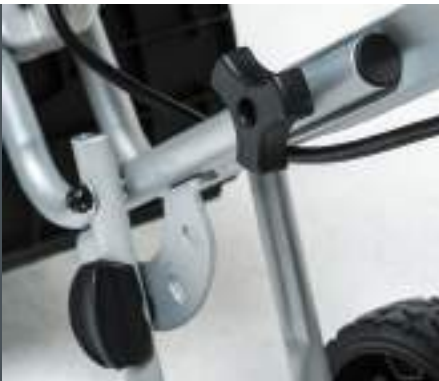
При обработке на максимальную глубину колёса откидываются вверх
