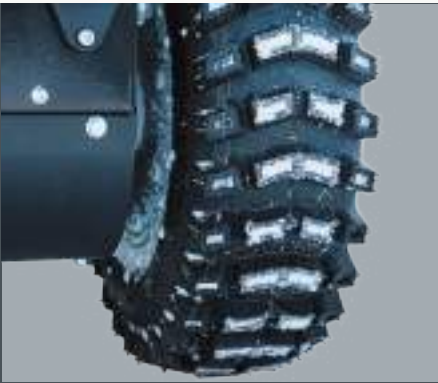
Высокая проходимость: колёса с глубоким протектором
