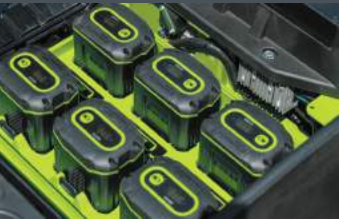
Шесть аккумуляторных батарей по 8Ач обеспечивают энергоёмкость 3,5 кВтч. Батареи размещены в защищенном отсеке под сидением
