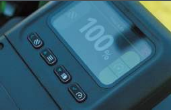
Строгая и интуитивно понятная панель управления с дисплеем. Дисплей отображает выбранную скорость движения, обороты ножей, процент заряда аккумуляторов, счётчик моточасов
