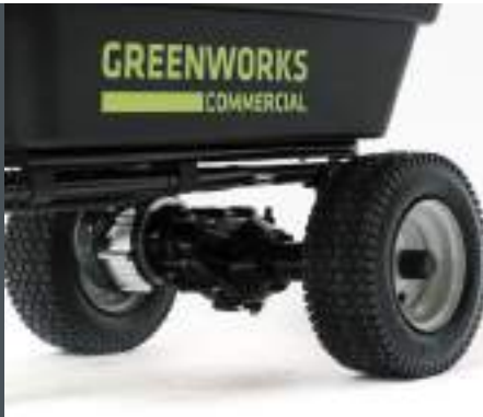
Привод на передние колёса для отличной манёвренности
